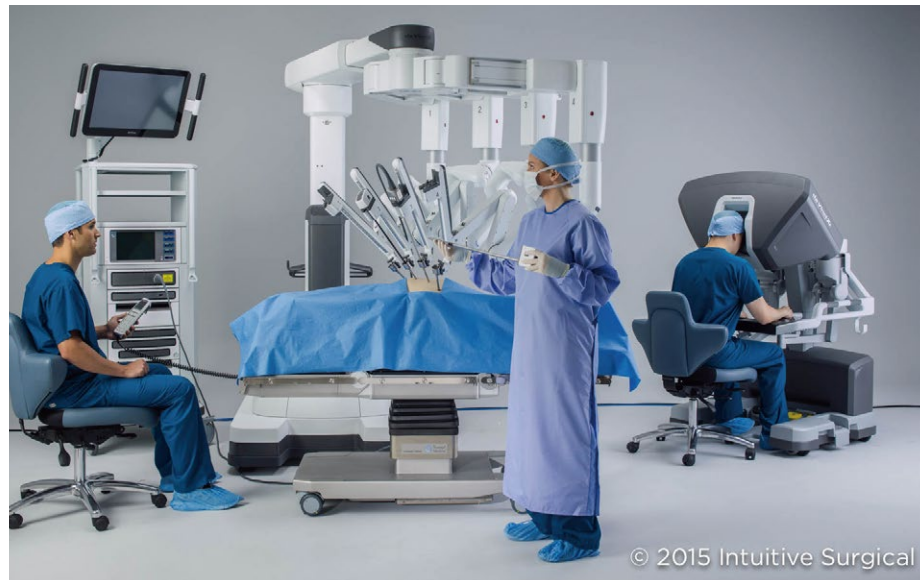
▲手術支援ロボット「ダヴィンチX」(左からビジョンカート、ペイシェントカート、サージョンコンソール)
